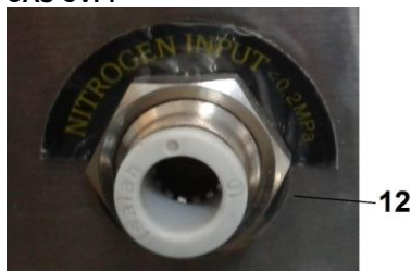
Widok złącza do podłączenia mieszanki gazowej MAP (dotyczy pakowarek w wersji GAS umożliwiającej pakowanie w atmosferze modyfikowanej MAP).
